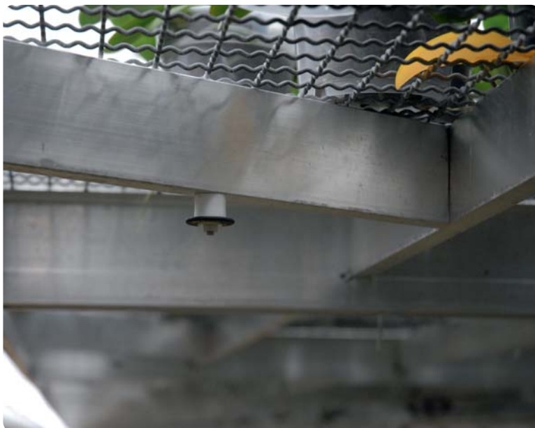
Bild 3: Jedes Rollbeet ist durch einen RFID-Datenträger TW-R30-B128 an der Unterseite eindeutig gekennzeichnet.
